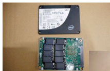
破壊前のSSD内部の画像
