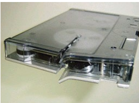
加圧損傷後のメディア
