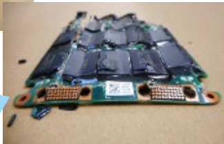
破壊後のSSD内部の画像
