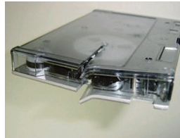
加圧損傷後のメディア
