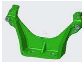
ジェネレーティブデザインを実施した「フロントエンジンマウント」 この設計を採用することで、質量を 23% 削減することに成功
