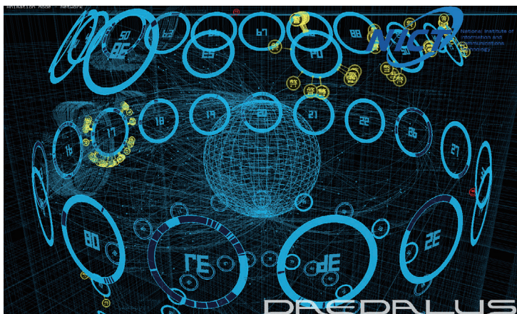
図 3 DAEDALUS は組織内の機器がマルウェア感染によって発信する攻撃パケットを検知しアラートを発報する
