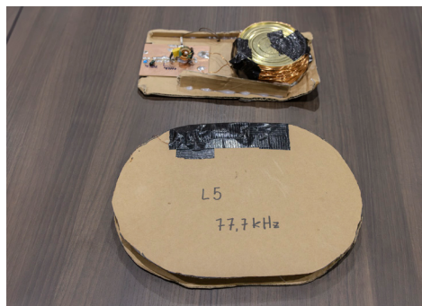
メレンデス氏が制作したデバイス、列車側のアンテナ（写真上）と線路側のビーコン（写真下）
