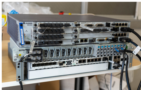
解析に使用した機器。上段からファーウェイ社の分散型基地局、中段が電源分配ユニット、下段がエリクソン社の基地局となっている
