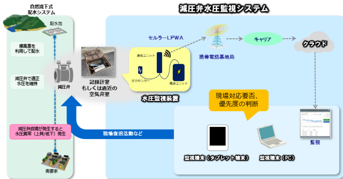
減圧弁水圧監視システムの概要
