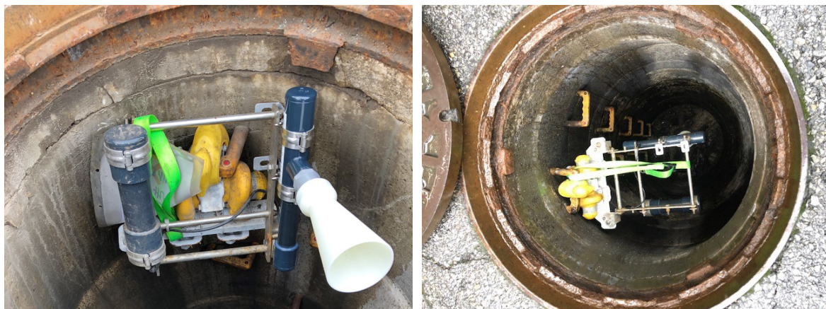
千葉市の下水道汚水マンホールにおける水位監視の実証実験の様子
