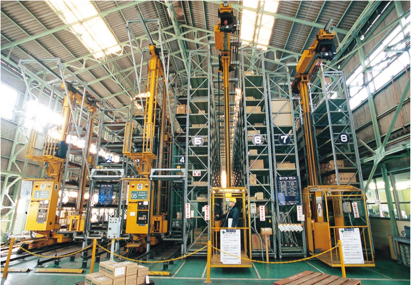
資材管理システム 2~3万種類の車両部品を効率よく管理できるようシステム化されている
